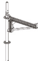
FIGUUR 41: Uitschuifbare consoles voor U-oplegging
